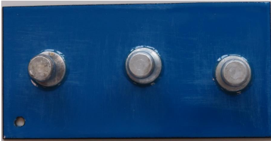
Applicazione del dolly sul campione
