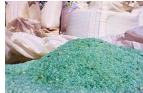
Le fritte sono la base per la messa a punto di formule appositamente studiate per le esigenze dei singoli clienti. Con questo prodotto si possono smaltare le superfici metalliche mediante una cottura che dura solo **pochi minuti** e a una temperatura molto più bassa (per l'acciaio intorno agli **800°C**).
